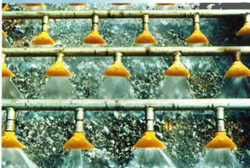
Wasch- und Siebanlage
